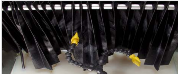
Stress test materiali - Prova di corrosione a nebbia di refrigerante
