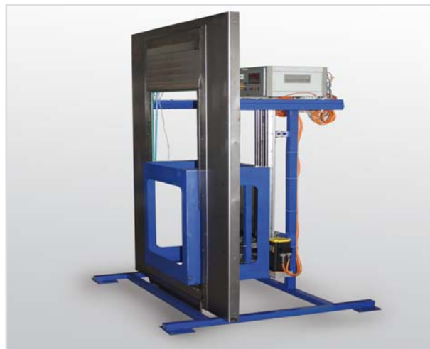
Test sistema asse Z con controllo dei componenti pneumatici e delle rotaie di guida
