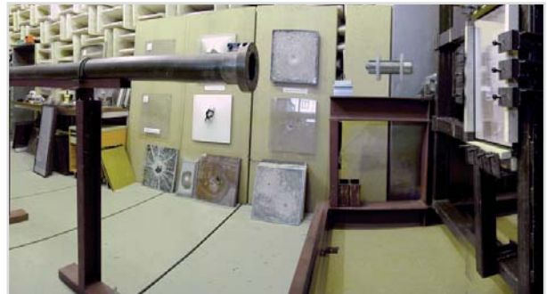
Prova d'urto vetri di sicurezza a norma DIN EN 12415
