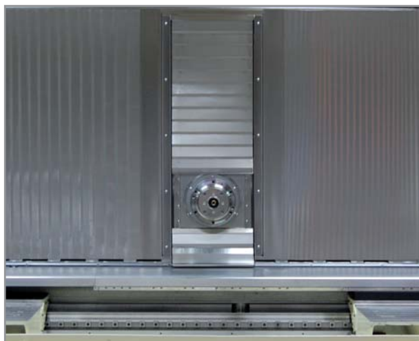
Esempio pratico del montaggio dei soffietti con lamella
