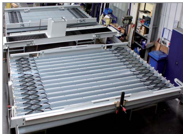
Test di montaggio del soffietto a tetto con lunghezza di più 9 metri e larghezza autoportante di 5 metri
