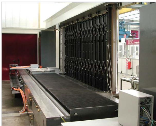
Test spostamento copertura a lamelle con sistema a pantografo al PTW, i rilevatori di forza misurano le vibrazioni allo spostamento
