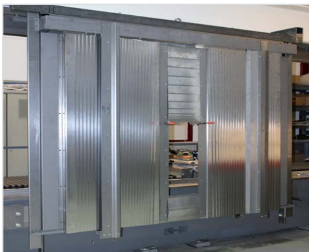
Test funzionale di una parete posteriore completa sul banco di prova alta velocità del PTW per l'analisi della pressione di contatto e della rumorosità
