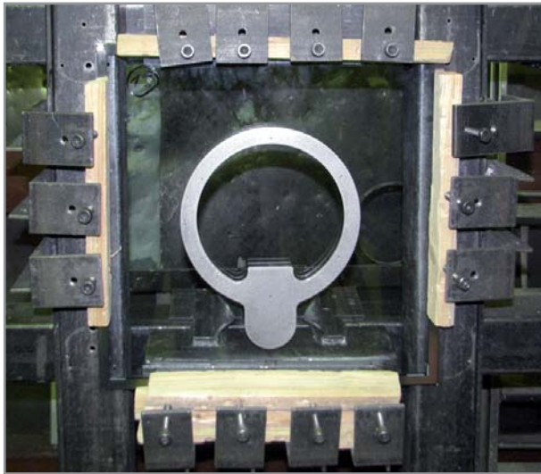
Sistema di fissaggio del pannello in prova con piastra di base per Visiport
