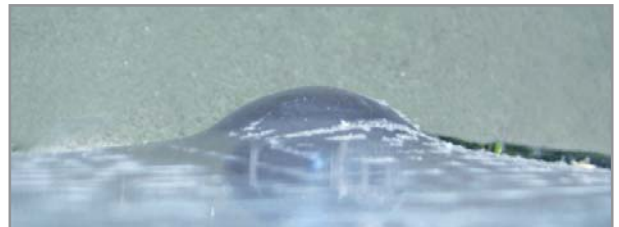
Deformazione corretta del policarbonato dopo l'impatto con il proiettile
