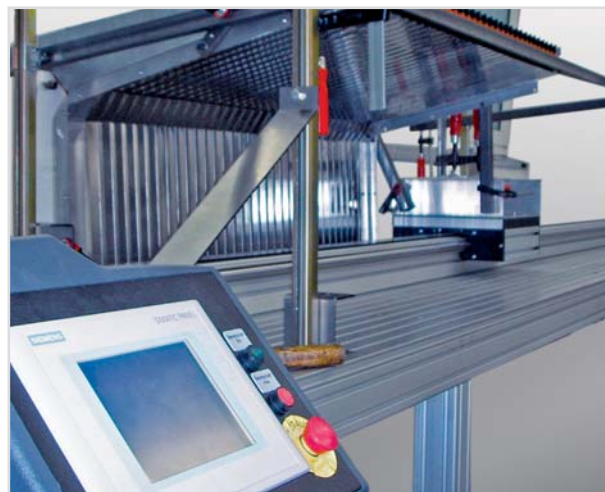
Test spostamento soffietto Vector con accelerazione elevata (fino a 4g)
