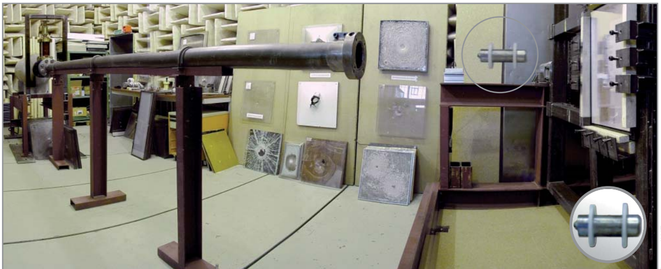
Vista panoramica del laboratorio dove sono stati effettuati i test (IWF del TU di Berlino). In primo piano, il cannone con il proiettile (ingrandito).
